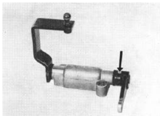
Bild G 17. Kerbstift für Hebelwelle
