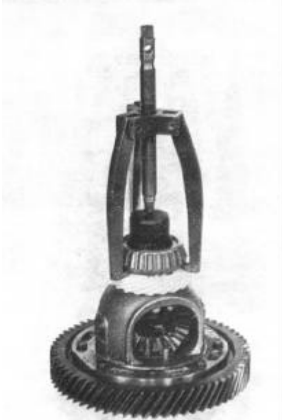
Bild G 26. Lagerinnenring des Kegelrollenlagers abziehen
