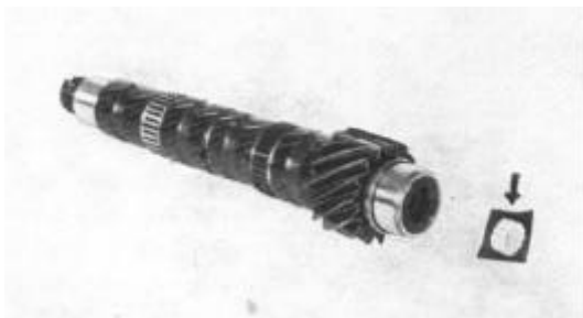
Bild G 23. Plastring für Öldurchlauf
