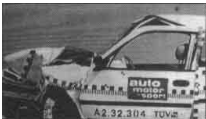
Zdjęcie 11. Auto Motor und Sport Spezial, 16/93. Nissan Sunny. "Poważne deformacje karoserii. Klatka pasażerska nie sprostała silnemu uderzeniu".
